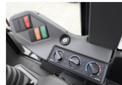
Console: de contactschakelaar, de bedieningselementen voor de verwarming en het optionele aircosysteem liggen binnen handbereik
