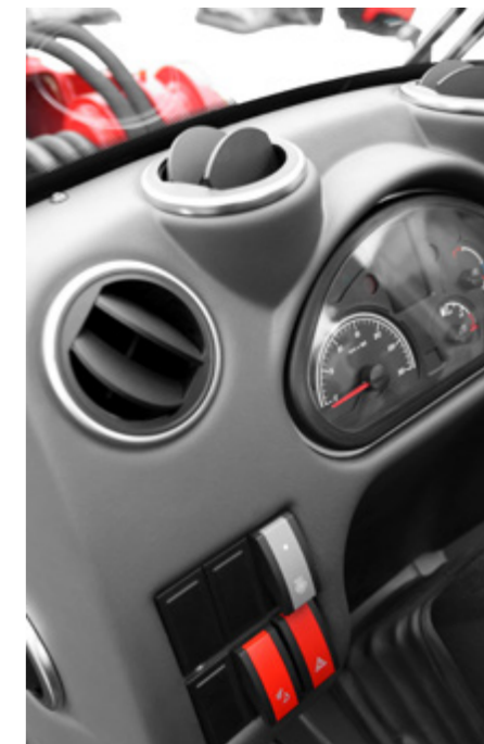
Extra grotere luchtuitlaten voor een perfecte luchtcirculatie / geoptimaliseerde serie schakelaars
